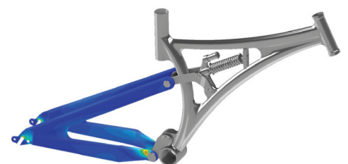
Resultados de tensão equivalente em conjunto de um quadro de uma mountain bike
